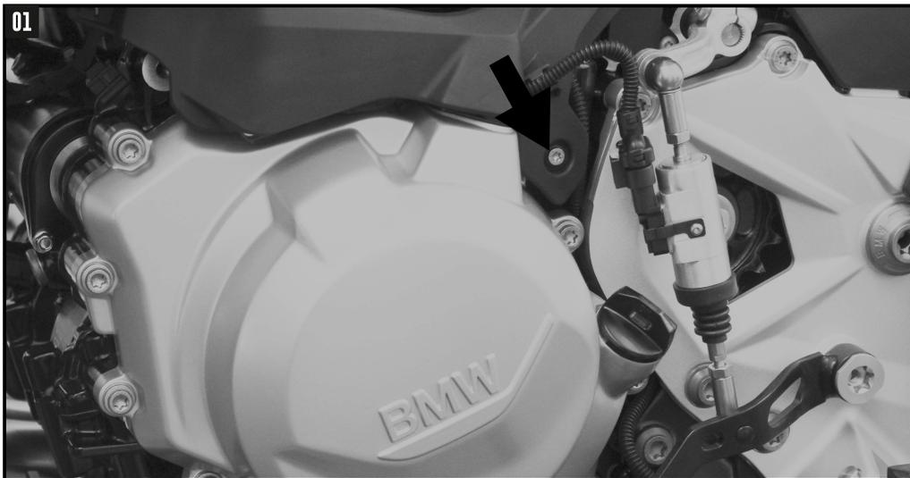
**Linke Seite:** Zur leichteren Montage auf der linken Seite die Kunststoffabdeckung der Kupplungseinstellung lösen. Hierzu die Torxschraube lösen und die Abdeckung von der vorderen Klemmung abziehen.
