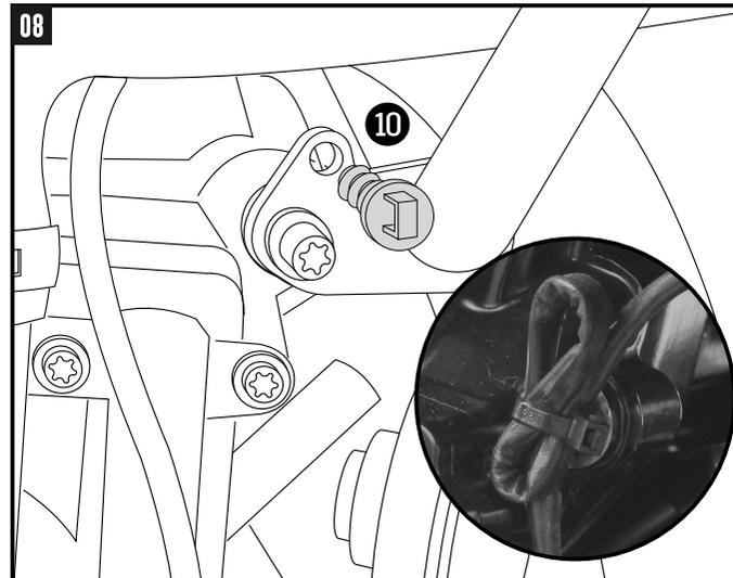
Den originalen Kabelhalter in die freie Bohrung der Lasche einstecken und das Lambdasondenkabel mit dem Kabelbinder wie original befestigen.
