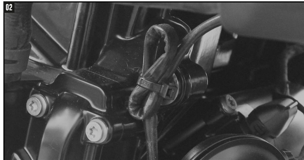
**Rechte Seite:** Auf der rechten Seite den Kabelhalter des Lambdasondenkabels aus dem Originalgewinde ausdrehen. Hierzu den Kabelbinder abtrennen und den Kabelhalter herausdrehen.
